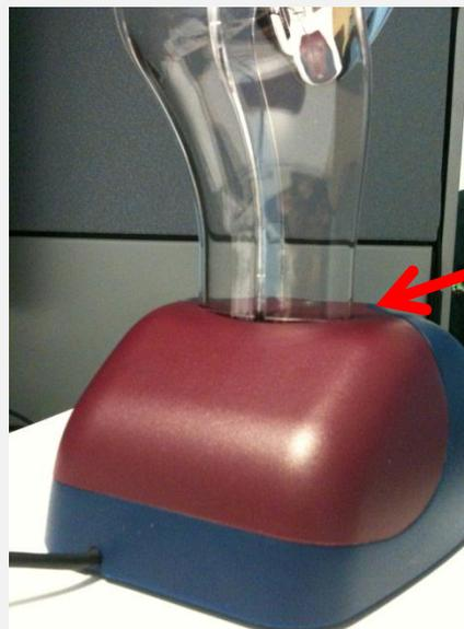
Debe notar que la línea (guía) en el brazo del equipo debe estar localizada de forma paralela a la parte superior de la base del equipo.
